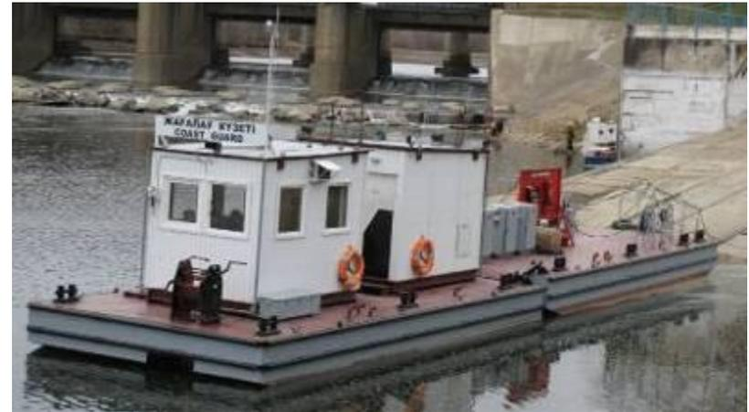
Предназначен для швартовки катеров и других плавсредств. Районы использования - берега рек, озер, водохранилищ. Допустимая ветровая нагрузка до 15 м/с.
