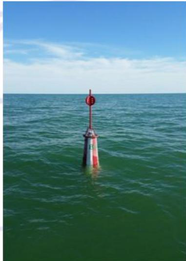
Буй морской малый ледовый светящийся, предназначен для ограждения морских каналов, фарватеров, рекомендованных курсов, а также отдельных навигационных опасностей в море в дневное и ночное время. Эксплуатационный период - круглогодичный, в том числе в ледовых условиях. В ледовых условиях при подвижке ледяного поля буй уходит под лед и выходит из-под льда в разводье.
