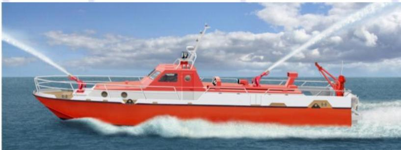
Судно предназначено для тушения пожаров на морских буровых установках и судах, стоящих у причалов, на рейде и в открытом море, а также для борьбы с огнём на береговых сооружениях
