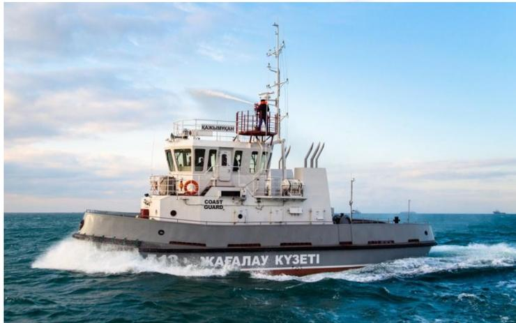
Ледокольно-буксировочный катер построен для эксплуатации в северной части Каспийского моря. Катер предназначен для проводки и буксировки судов в ледовой обстановке.
