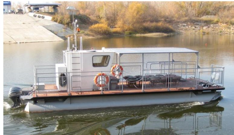
Паром речной самоходный предназначен для перевозки людей в количестве до 20 человек и грузов между берегами равнинных рек и озер.
