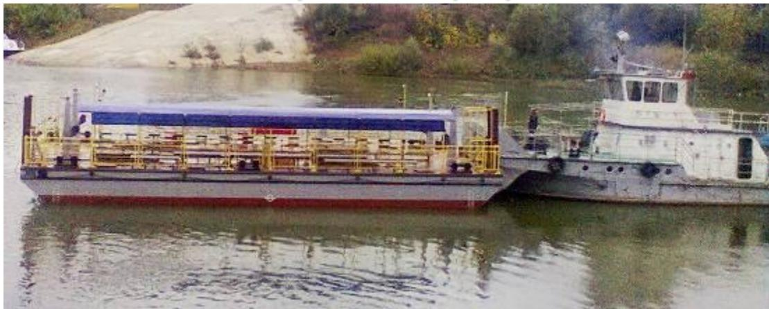
Стальной сварной понтон предназначенный для паромной переправы по перевозке автотранспорта и пассажиров через реки разряда «Л», с грузовой площадкой для размещения автотранспорта и площадкой защищенной тентом для размещения пассажиров. Движение осуществляется с помощью буксировщика по натяжному тросу, закрепленному на разных берегах реки.
